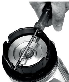
Om blenderkannans knivsats är svår att vrida loss, ta hjälp av en skruvmejsel eller liknande (se bild).
