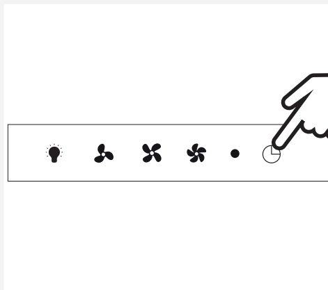
Glas Touch panel: Hold "Timer" inde i 15 sekunder. Emhætten vil nu være åben for paring i et minut
