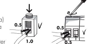
Om du skall ansluta två eller fler ledare i samma kopplingsplint (oavsett ledararea) gör följande: Använd metallisk presshylsa (använd krymp verktyg) till alla 0,5 mm<sup>2</sup> ledare och anslut normalt i kopplingsplinter
