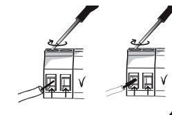
Jos liität vähintään kaksi johdinta samaan liitintään (tyypistä huolimatta), toimi seuraavasti: Kiinnitä metallinen puristin (kayta puristusyokalua) kaikkiin  $0,5 \text{ mm}^2$ :n johtimiin ja kytke johdinta peittävät puristimet liitintään kaikkien muiden johdintyyppien kanssa. Kiinnitä tämän jälkeen normaalisti.
