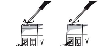
Om en ledare (0,5 mm<sup>2</sup>) ansluts till en kopplingsplint med tryckplatta kan den fästas med eller utan metallisk presshylsa.
