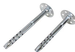
Hammerfixplugg. Brukes til montering på betong eller mur. Forborres med 8mm bor og skal ha minst 5cm forankring i underlaget.
