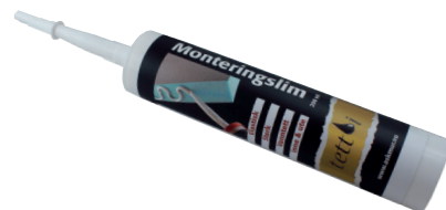
Monteringslim for våtromsplater, 290 ml Fuktherdende 1-komponent lim på SMP basis. Inneholder ikke løsemidler. Brukes til å lime våtromsplater mot alle overflater.
