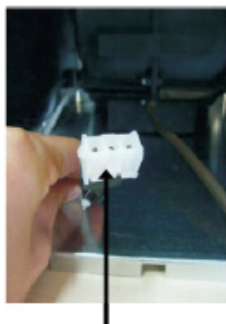
Conexión de la toma del portalámparas
