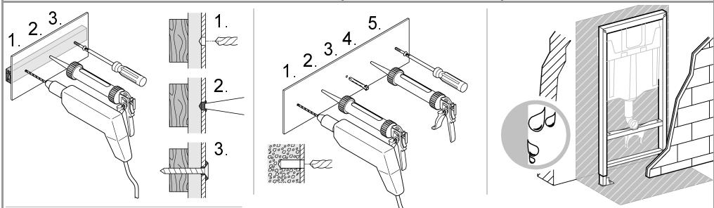
Skrufinfästningar i vätzon 1 ska göras i betong eller annan massiv konstruktion, träreglar, träkortlingar eller i konstruktion som är provad och godkänd för infästning, till exempel skivkonstruktion. Se exempel på godkända konstruktioner på säkervatten.se. Skruvinfästningar i vätzon 1 får inte göras enbart i golv- eller väggskiva.
