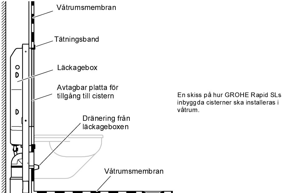
Inbyggnadscisternen är att betrakta som vattentätt utrymme med läckageindikering enligt SäVa §3.6.2 och RISE C900614 och Apex Seal Solution C900125, om denna monteringsanvisning och branschreglerna följs.
