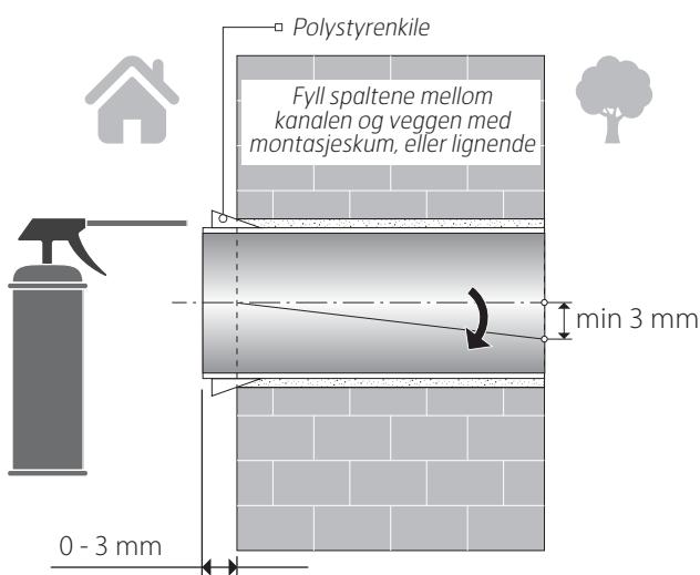
Sett kanalen inn i veggen som vist i figuren til venstre. Installer kanalen med minst 3 mm helling utover. På ytterveggen må enden av kanalen flukte med veggene.
