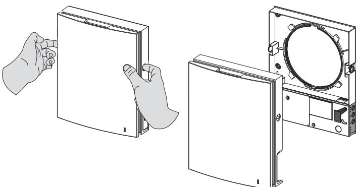
5. Fest den bakre delen av innvendig del på veggen med skruene som følger med romventilatorens monteringssett.
