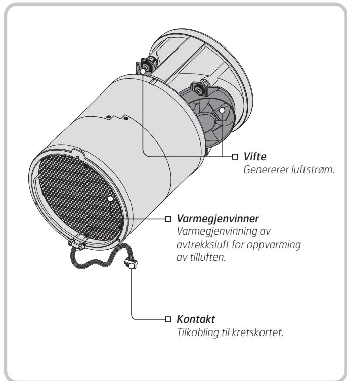
Kassetten er en massiv blokk og kan ikke demonteres. Kontakten fra kassetten kobles til kretskortet i den bakre delen av innendørsenheten.
